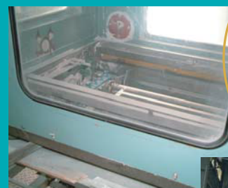
蛍光灯破碎機
